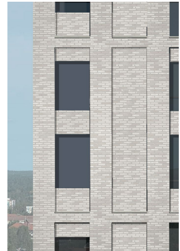
Kahden kerroksen korkuinen julkisivujako, ikkunajulkisivu Jaon tulee erottua myös umpiseinässä tiilimuurausta sisentämällä. Periaatekuva
